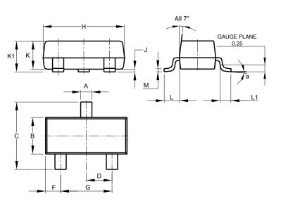
SOT23 Dim Min Max Тур 0.51 0.40 Α 0.37 В 1.20 1.40 1.30 С 2.30 2.50 2.40 D 0.89 1.03 0.915 0.45 0.535 F 0.60 G 1.78 2.05 1.83 Н 2.80 3.00 2.90 J 0.013 0.10 0.05 Κ 0.890 0.975 1.00 **K1** 0.903 1.10 1.025 L 0.45 0.61 0.55 L1 0.25 0.55 0.40 М 0.085 0.150 0.110 0° 8° а ---All Dimensions in mm
